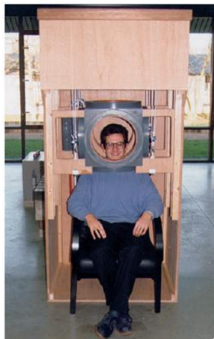
Experimentele opstelling voor het bestuderen van effecten van het magnetische veld (50 Hz) op het lichaam.
