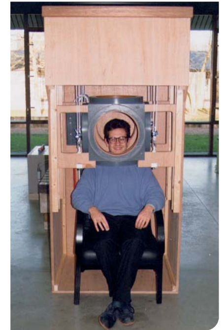
Experimentalaufstellung zum Studium der Effekte des magnetische Feldes (50 Hz) auf dem Körper.
