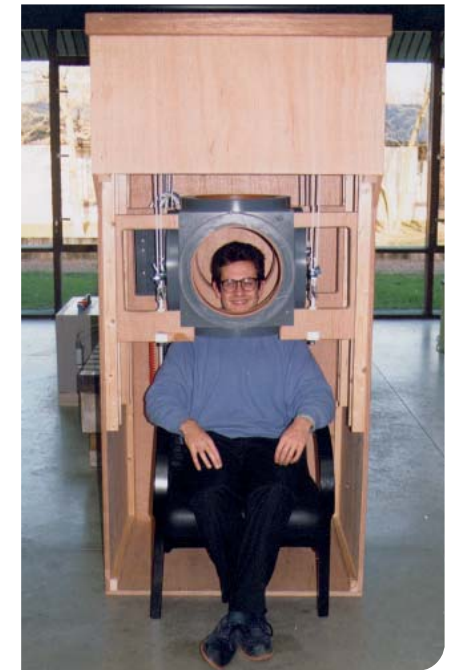
Experimentele opstelling voor het bestuderen van effecten van het magnetische veld (50 Hz) op het lichaam.
